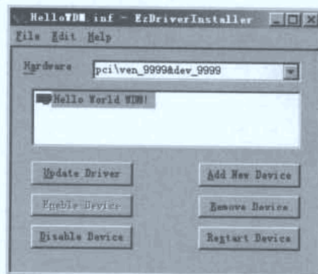
图 13-4 用 EzDriverInstaller 加载 WDM 驱动
