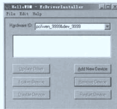
图 1-25 用 EzDriverInstaller 安装 HelloWDM 驱动
